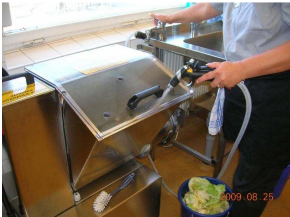
Figur 17. Köksavfallskvarn i storkök. Kvarnen matas med vatten och locket skyddar mot stänk och säkerställer att ingen kan stoppa ner fingrar eller ovidkommande föremål när kvarnen maler. Foto: Linda Irebrand
