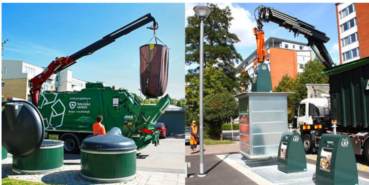
Figur 10. Tömning av underjordsbehållare från Sansac. T.v. delvid nedgrävd där locket öppnas och en bottentömmande säck lyfts upp. T.h. helt nedgrävd där en bottentömmande container lyfts i en fästpunkt på inkastet. Foto: Sansac
